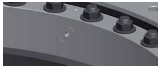
Härteschlupf am Stopfen / Soft spot пробки
